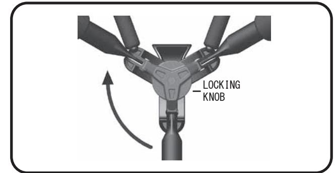
3本全ての足が正常に開いた位置にできたら再びスタンド底部のロッキングノブを時計回りに1/4回転させロックします。
