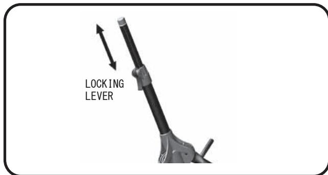
スタンドの高さを調節する為には背面のロッキング・レバーを上に持ち上げ解放し、高さを調整したらロッキング・レバーを下げて固定します。
